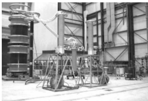
شکل ۳: مجموعه تست فشار قوی برای OVT 230 کیلوولت
