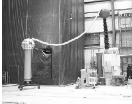
شکل ۱: مقسم ولتاژ مرجع در سمت چپ، ترانسفورماتور قدرت در سمت راست
